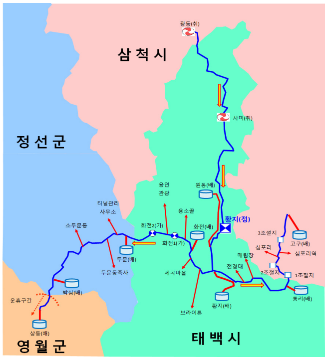
<그림 4-2> 용수공급 시스템의 전체 구성
