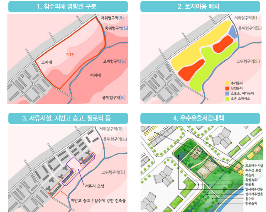
그림 9. PSR 기반의 재해저감 도시설계기법 개발방향 예시
