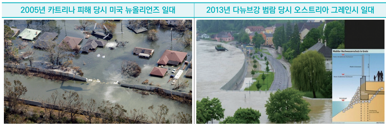
〈그림 8〉 집중호우로 인한 제방 붕괴(좌) 및 가변식 차수벽 설치에 따른 침수피해 저감 사례(우)
