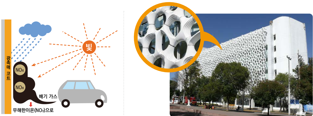
〈그림 5〉 광촉매 원리와 멕시코 병원의 광촉매 벽체 설치
