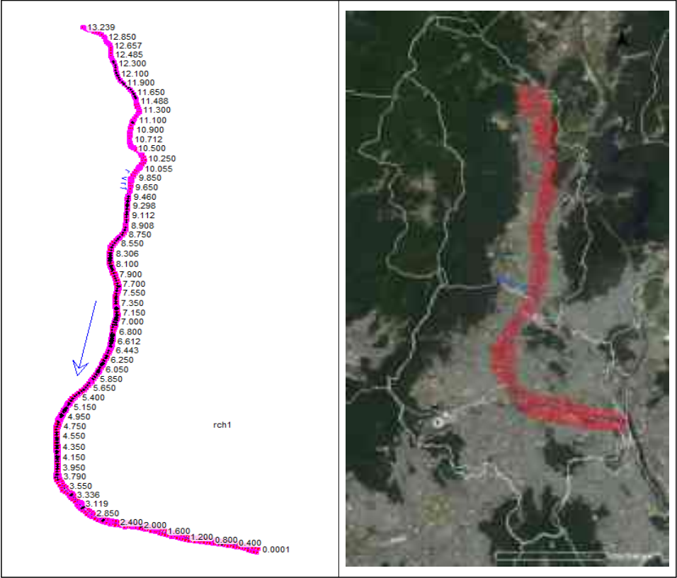
그림 2-5 | 하천 수위 모의를 위한 HEC-RAS 구축 과 횡단 측선 자료 구축
