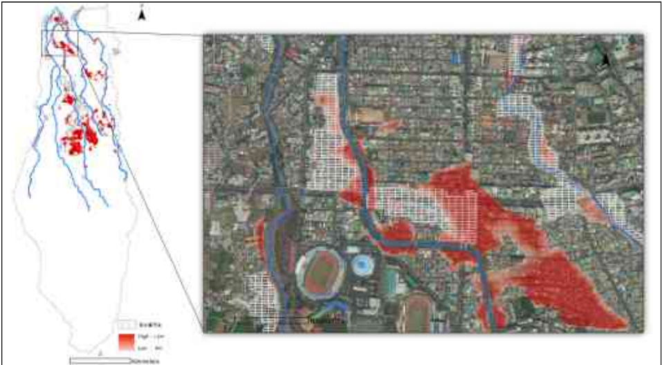
그림 3 | 외수범람 해석 및 결과 검증 : 제주특별자치도 대상지역의 예
